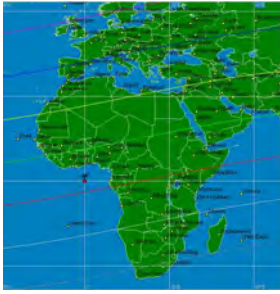
Fig. ANOMALIA EQUATORIALE: Perché il meccanismo della TEP funzioni è necessaria un'elevata ionizzazione in entrambi i lati della regione ionosferica curva. Sui 144 mhz la ionosfera è molto esigente e critica, pertanto le condizioni favorevoli in grado di supportare le aperture sono davvero rare. Lo strato F deve avere di base un'elevata ionizzazione residua e questo si verifica durante la fase massima del ciclo solare. Inoltre gli emisferi devono essere equamente illuminati dal sole (periodi equinoziali) con condizioni di tempo meteorologico buono corrispondente ad estesi fronti di alta pressione in entrambi i lati dell'equatore. Nella figura è illustrato in sintesi il percorso del segnale: la prima riflessione avviene nella regione F2 ad una distanza di oltre 2000 Km. dal trasmettitore. Sui 144 Mhz, grazie alle antenne direttive ad alto guadagno e poste a parecchie lunghezze d'onda dal suolo è possibile ottenere angoli d'irradiazione molto bassi e quindi per un semplice effetto trigonometrico è possibile ottenere distanze di salto decisamente più lunghe rispetto alle gamme HF.
